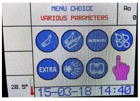
4) PRESS THE KEY 1 (CYCLE URINE BOTTLE)  $\rightarrow$  TO ENTER THE VARIOUS PARAMETERS
